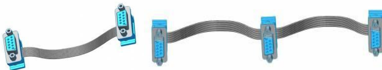
Рис. 13. Образец шлейфов с разъемами DB-9F(M) под обжимку
